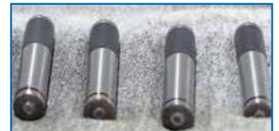
Inox plunjers met keramische bekleding
