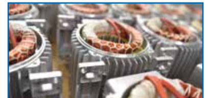
Traagdraaiende motoren (1400 t/min)
